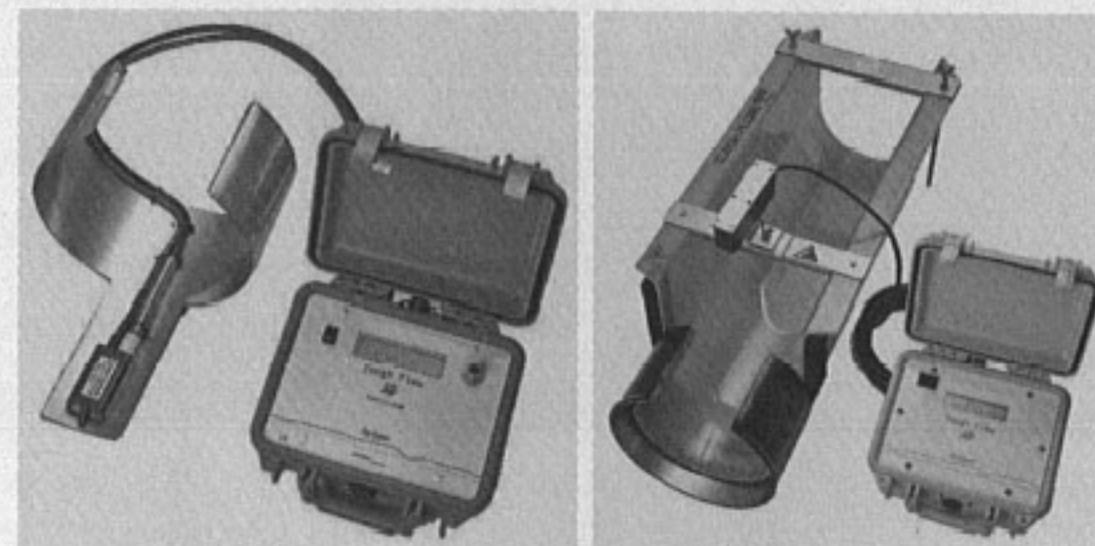
不明水を定量するためのワンタッチ流量計群
